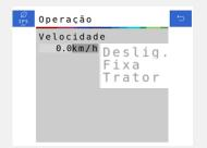
Al habilitar la simulación de velocidad, las funciones de corte automático, compensación de curvas y mapeo se desactivarán automáticamente
