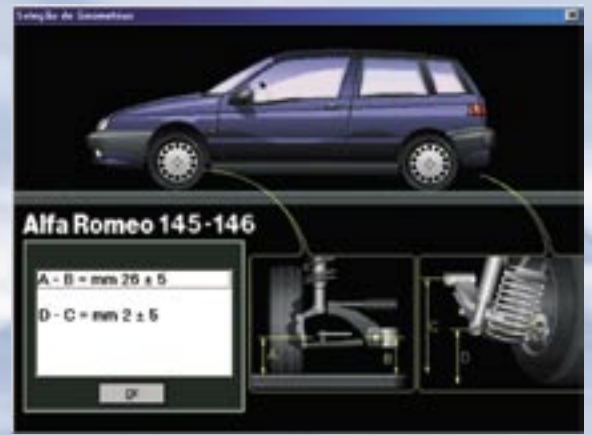
Software en ambiente Windows, imágenes en 3D con ilustraciones de los puntos de ajuste de los vehículos.
